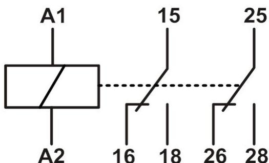
Напряжение питания подаётся на клеммы «+A1», «A2».
